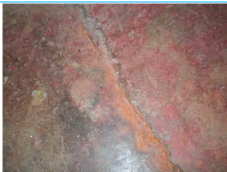
Matériaux : ZPSO-S16 Prélèvement : P272 Description : Ragréage et peinture de sol Localisation : RdC - 028 Résultat : Absence d'amiante
