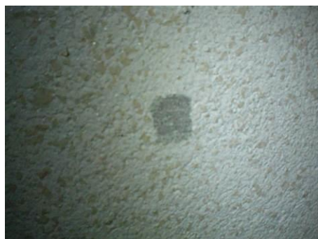
Matériaux : ZPSO-M04 Prélèvement : P208; P221 Description : Peinture pailletée blanc crème Localisation : RdC - 037; RdC - 039 Résultat : Absence d'amiante Quantité :
