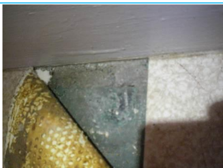
Matériaux : ZPSO-S14 Prélèvement : P257; P269 Description : Dalle de sol 22*22 verte et colle noire sous dalles souples 33*33 Localisation : R1 - 017; R1 - 018b; R1 - 034; R1 - 020; R1 - 022; R1 - 024b; R1 - 033; R1 - 026; R1 - 027; R1 - 021; R1 - 019b; R1 - 031; R1 - 016 Résultat : Présence d'amiante
