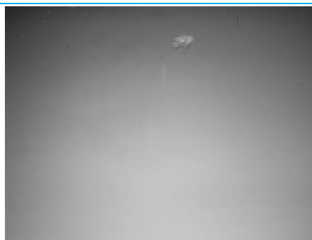
Matériaux : ZPSO-PI3 Prélèvement : P275 Description : Enduit plâtre plafond Localisation : RdC - 028 Résultat : Absence d'amiante
