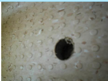
Matériaux : ZPSO-S12 Prélèvement : P245; P249 Description : Colle de carrelage grès cérame gris sous Tarkett douche Localisation : R1 - 039; R1 - 010; R1 - 038; R1 - 003; R1 - 004; R1 - 037; R1 - 009; R1 - 036 Résultat : Absence d'amiante Quantité : m2
