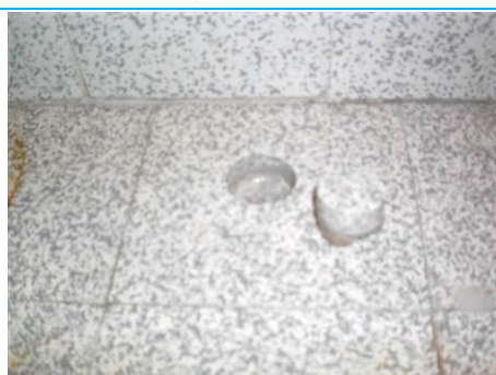
Matériaux : ZPSO-S07 Prélèvement : P224; P231 Description : Colle de carrelage grès cérame 10*10 gris Localisation : RdC - 019; RdC - 026; RdC - 025; RdC - 020 Résultat : Absence d'amiante Quantité :
