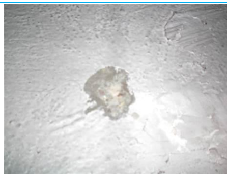
Matériaux : ZPSO-M11 Prélèvement : P273 Description : Enduit ciment murs périmétriques Localisation : RdC - 028 Résultat : Absence d'amiante
