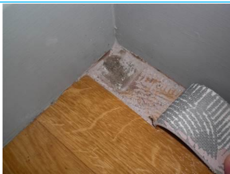
Matériaux : ZPSO-S08 Prélèvement : P223; P230 Description : Colle et ragréage sous sol souple imitation parquet Localisation : RdC - 023; RdC - 026b; RdC - 024 Résultat : Absence d'amiante Quantité :
