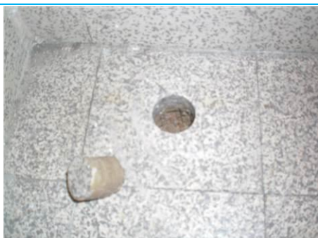
Matériaux : ZPSO-S13 Prélèvement : P261; P270 Description : Colle de carrelage grès cérame 10*10 gris Localisation : R1 - 015; R1 - 018; R1 - 024; R1 - 032; R1 - 019 Résultat : Absence d'amiante Quantité :
