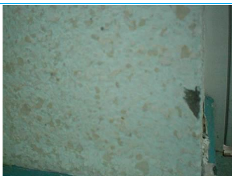
Matériaux : ZPSO-M07 Prélèvement : P237; P240 Description : Peinture pailletée blanc crème sur enduit ciment Localisation : R1 - 035; R1 - 030 Résultat : Absence d'amiante Quantité :
