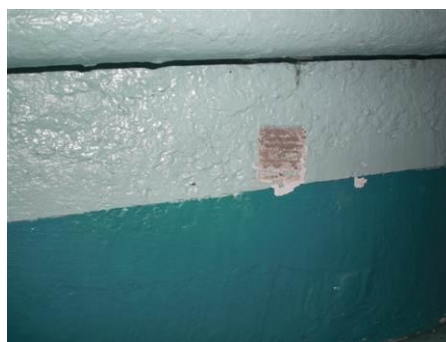
Matériaux : ZPSO-M06 Prélèvement : P236 Description : Peinture pailletée verte sur enduit ciment Localisation : RdC - 040; R1 - 029; R1 - 028 Résultat : Absence d'amiante Quantité :
